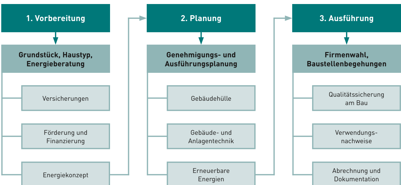
Abb. 4 Ablaufplan eines Neubau- oder Sanierungsvorhabens
