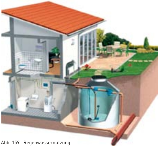
Abb. 159 Regenwassernutzung © Müller Schachttechnik GmbH
