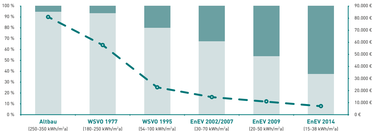
Abb. 150 Verhältnis Transmissions-/Lüftungswärmeverlust in Abhängigkeit vom energetischen Standard, bezogen auf 110 m 2 beheizte Fläche und 135 m 3 /h Nennluftmenge gemäß DIN 1946T6
