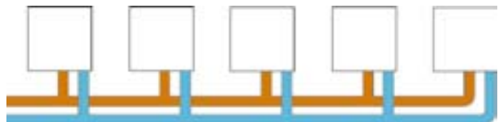
Abb. 138 Zweirohrheizung – Gleichlaufprinzip © SAENA
