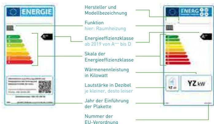
Abbildung 2: Energieeffizienzlabel für bestehende und neue Heizungen
