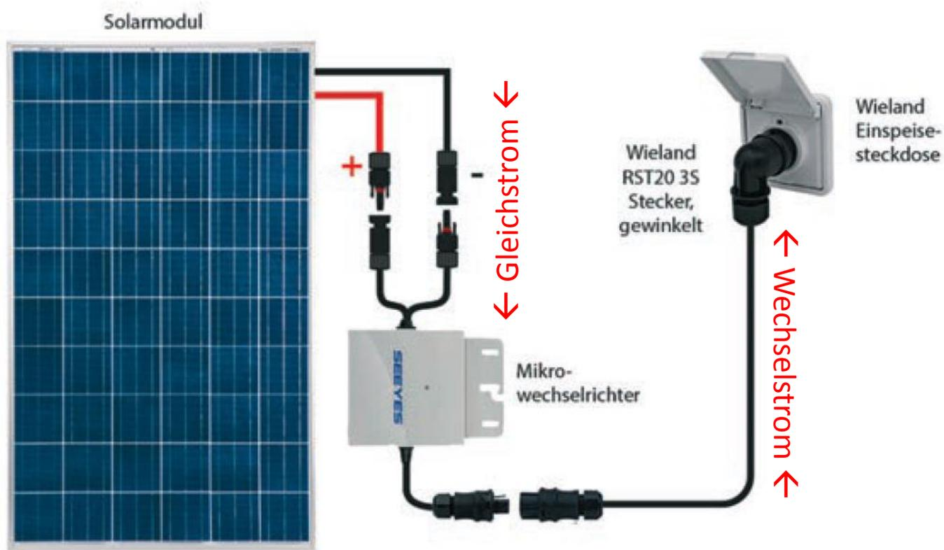
Abbildung 56: Schematischer Aufbau steckerfertige Anlage (© Bosswerk GmbH & Co. KG)
