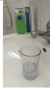
Bild 2: Messung der Durchflussmenge mit einem Messbecher. Zusätzlich wird eine Uhr mit Sekundenzeiger oder eine Stoppuhr benötigt
